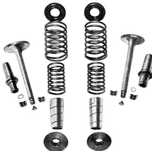
図 20 Jupiter VII.F 型の吸排気弁回りの部品展開写真
