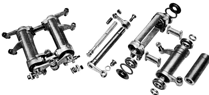
図 19 Jupiter VII.F 型ロッカー回りの部品展開写真
