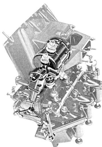
図 33 Bristol 昇流式 3 聯気化器への ABC 装備状況
