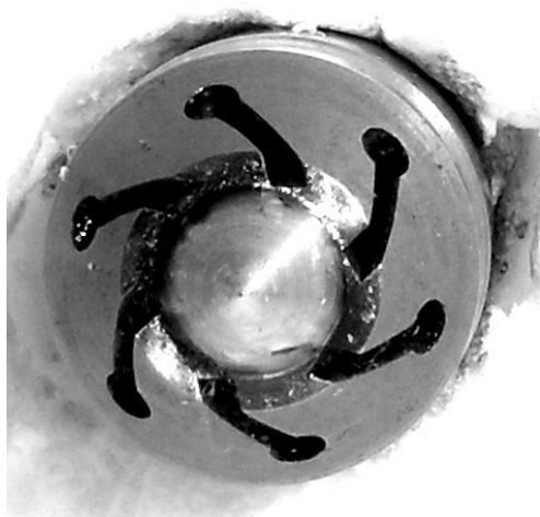
図 II - I -28 ノズル弁先端の小孔と渦巻き状の溝
