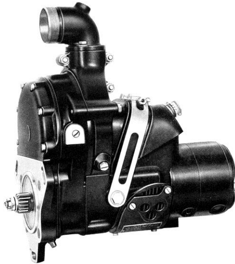
図-補Ⅱ-10 複列 14 気筒発動機用 Bendix Scintilla SF14LN-3 型高圧マグネトーの外観
