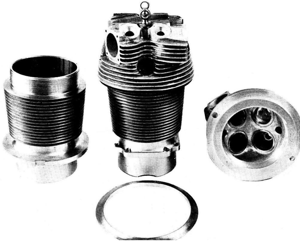
図Ⅲ-Ⅱ-17 Jupiter (F付モデル)のねじ込み・焼嵌式 Y 合金鍛造削り出し気筒頭と気筒
