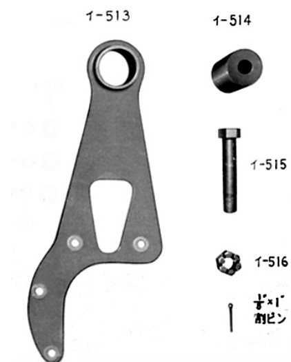
図 8-7 15 年度型 “くろがね四起” における “発動機懸垂板”
