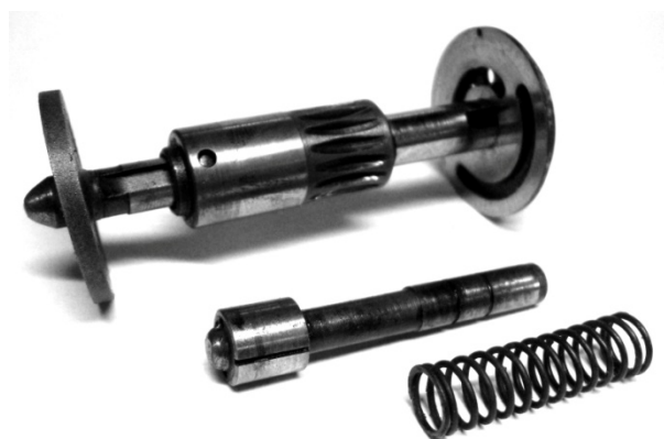
図 4-7 1934 年型ハーレー送油ポンプの主運動部
