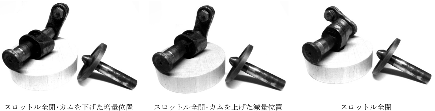
図 4-9 1934 年型ハーレー送油ポンプにおけるカムの働き
