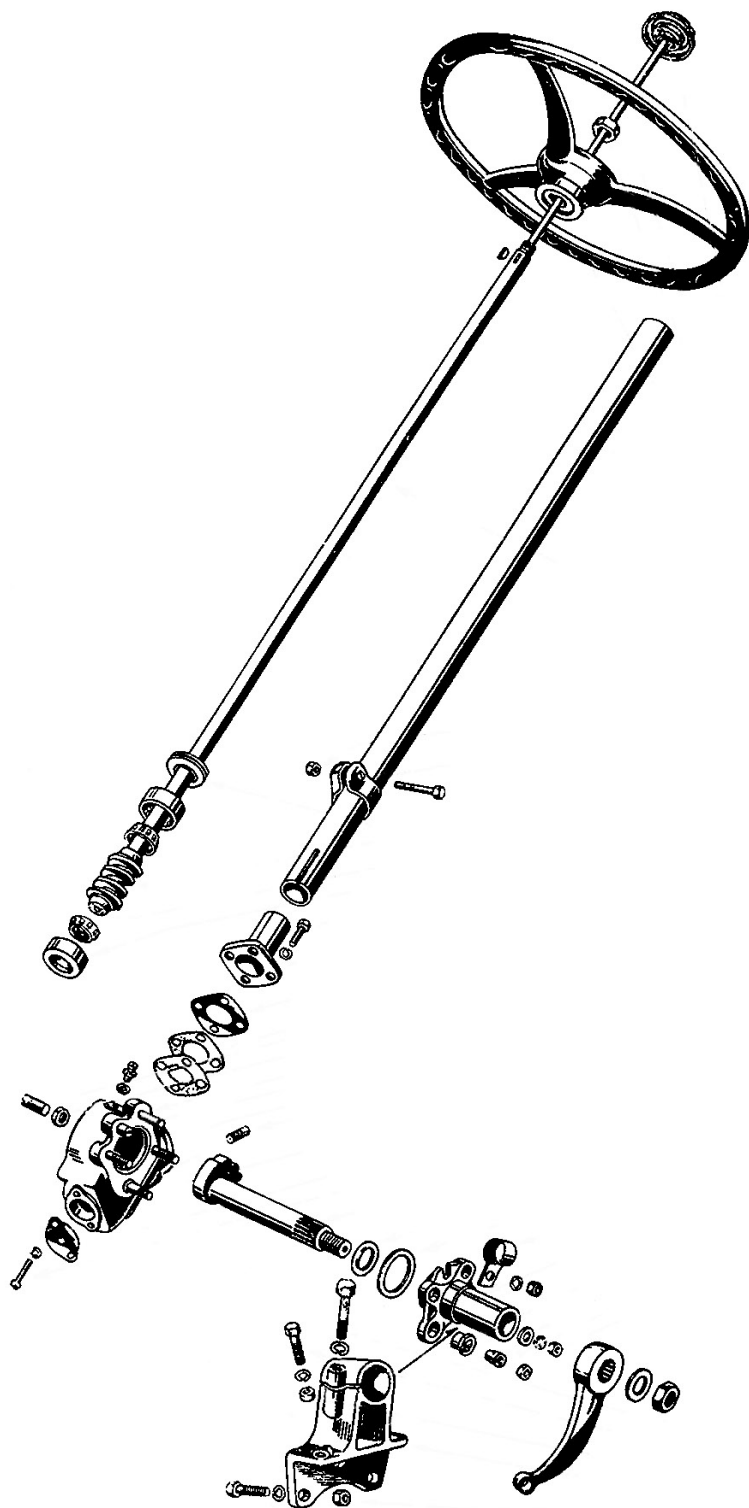
図 7-37 “くろがね四起” のステアリング・ギヤ回り(2)
