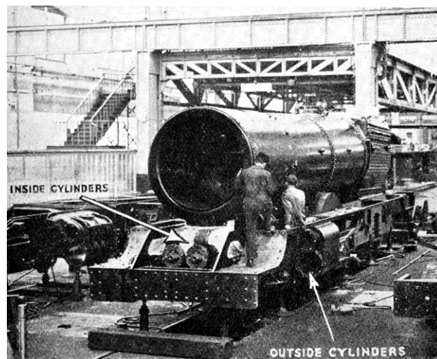
図 II-2-2 組立中の King 級単式 4 気筒機関車
