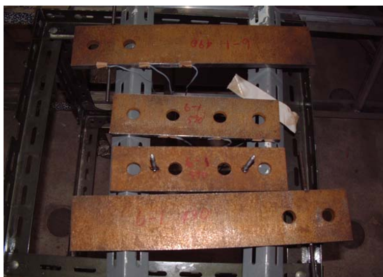
写真9 接合面の状態(No.6-1)試験前
