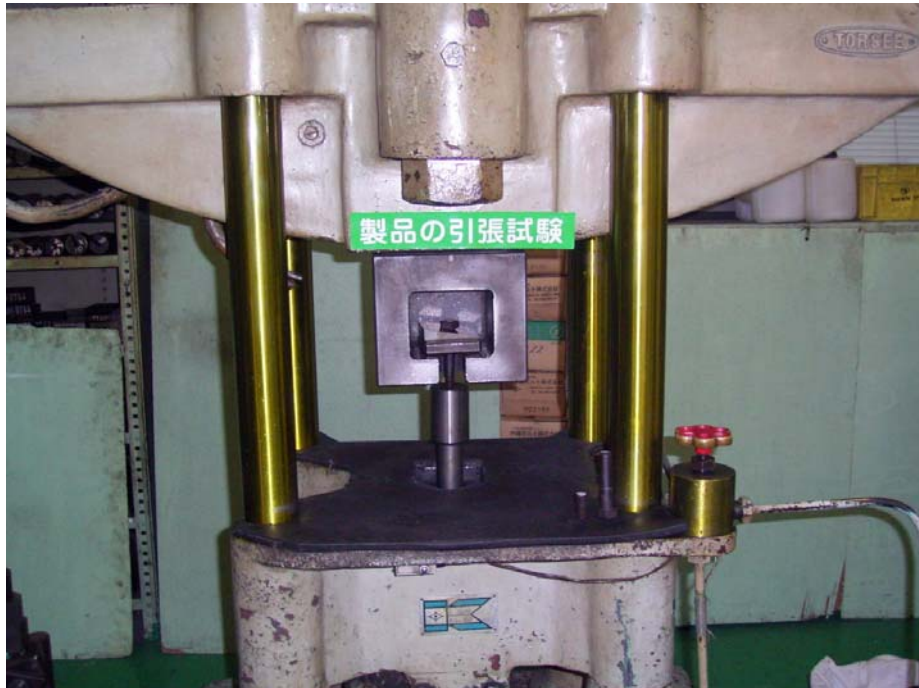
写真1 引張試験時の様子
