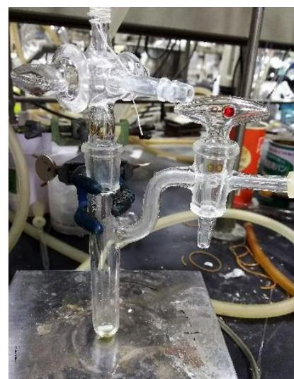
図 1 シュレンク管を用いて反応を行っている様子
