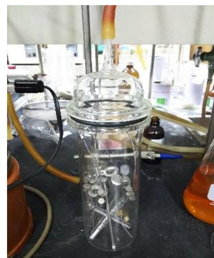
図 2 マイクロシリンジ用デシケーター
