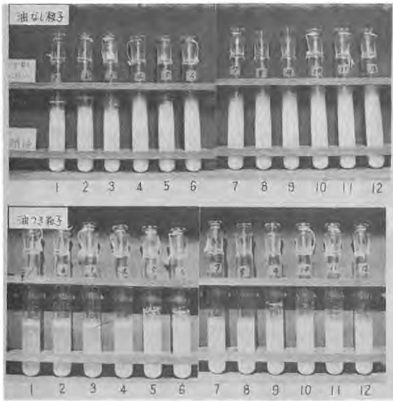
写真-3 カオリン粒子(油の有無)の分散性
