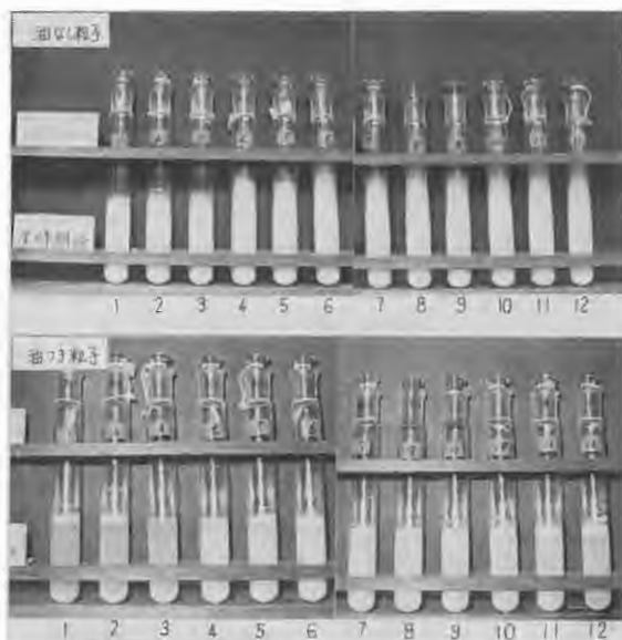
写真-5 カオリン粒子(油の有無)の分散性
