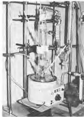
写真一2 泡沫洗浄装置(1)
