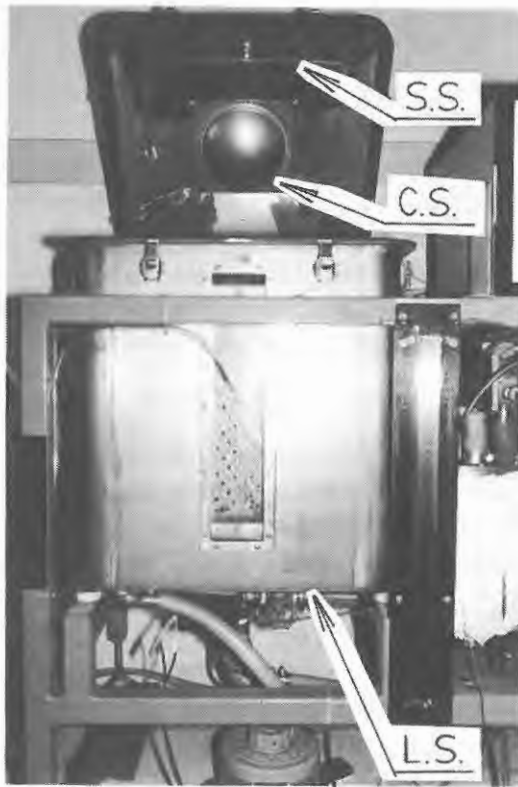
写真5 洗濯槽 (L. S) およびすすぎ用シャワー (中央シャワー=C. S, 周辺シャワー=S.S)
