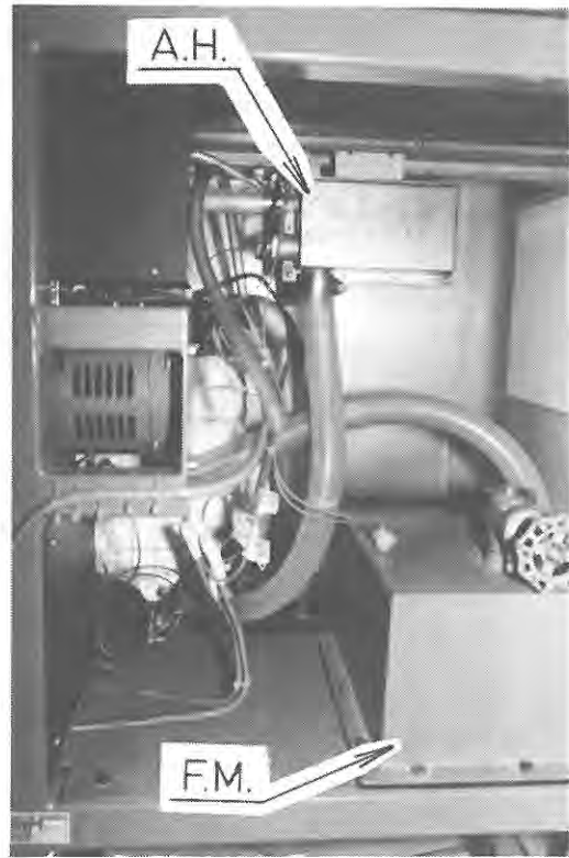
写真4 送風用ファンモーター (F. M) および空気加熱箱 (A. H)
