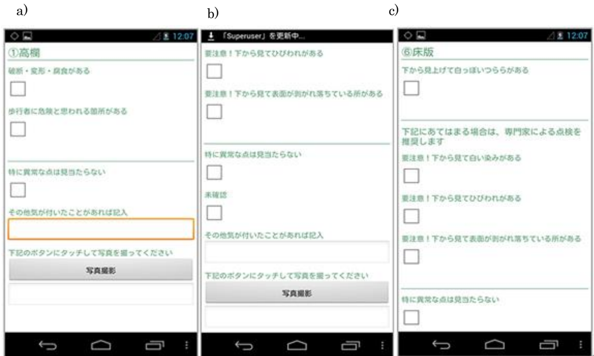
図 8 点検項目画面例 a) 「①高欄」点検画面 b) 「未確認」ボタン c) 要注意点検項目
