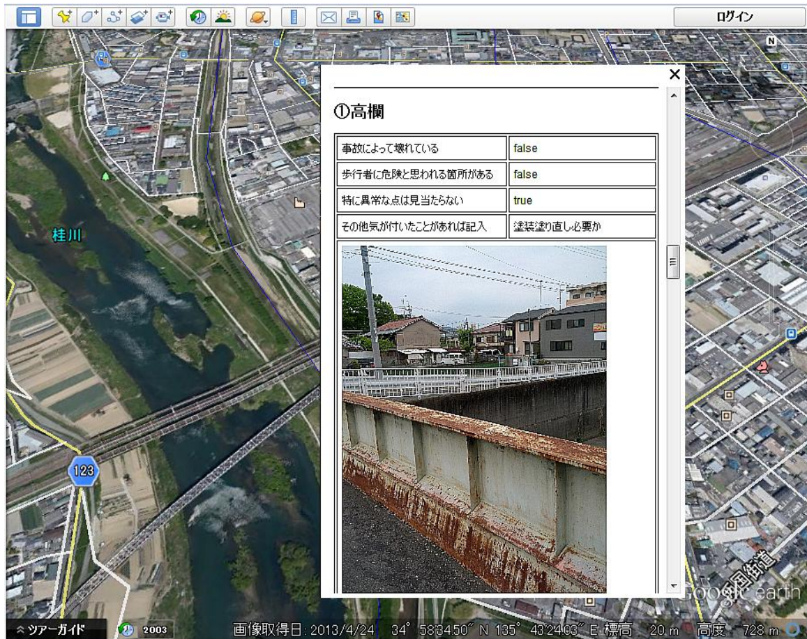
図 9 GoogleEarth 上での点検結果表示例
