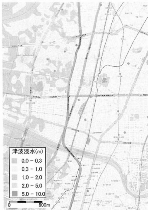
図4 住吉区西部の南海トラフ巨大地震で想定される津波浸水深 大阪府(2011)の資料をもとに作成
