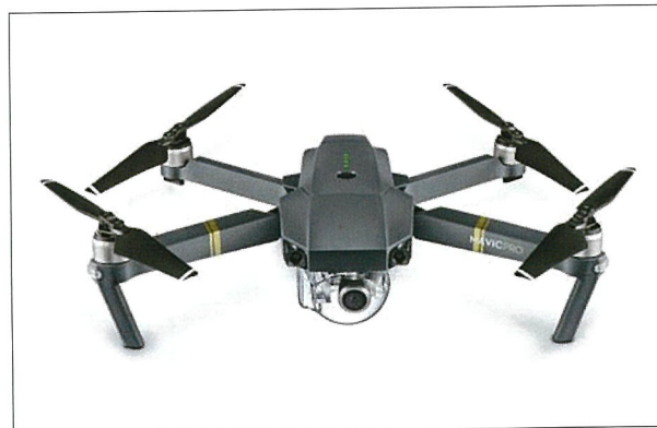
図2 DJI社製 Mavic Pro(対角寸法:335mm、重量:734g)
