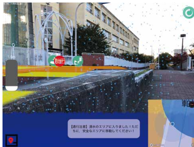
図18 避難所、防火水槽、水害時避難ビルのアイコンが表示されているAR表示画面
