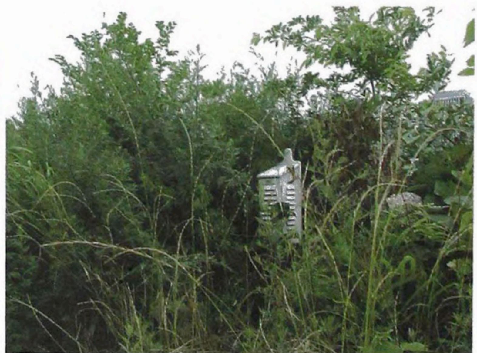
資料写真 4.2.2-14 本庁舎屋上緑化施設 北東の百葉箱 (2005年6月)
