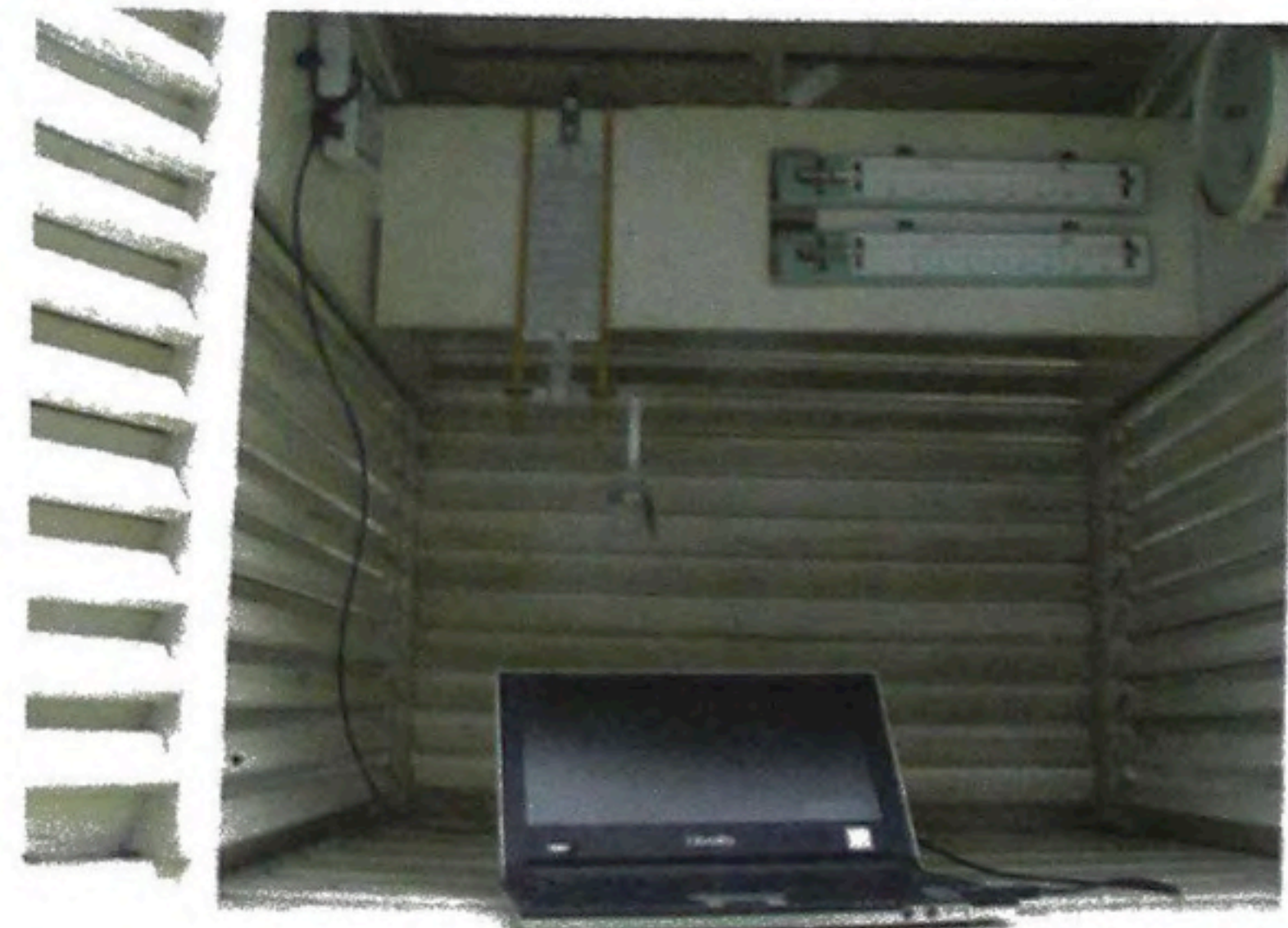
資料写真 3.2.1-5 百葉箱内部 左上部のデータロガーから、 パソコンにデータを転送
