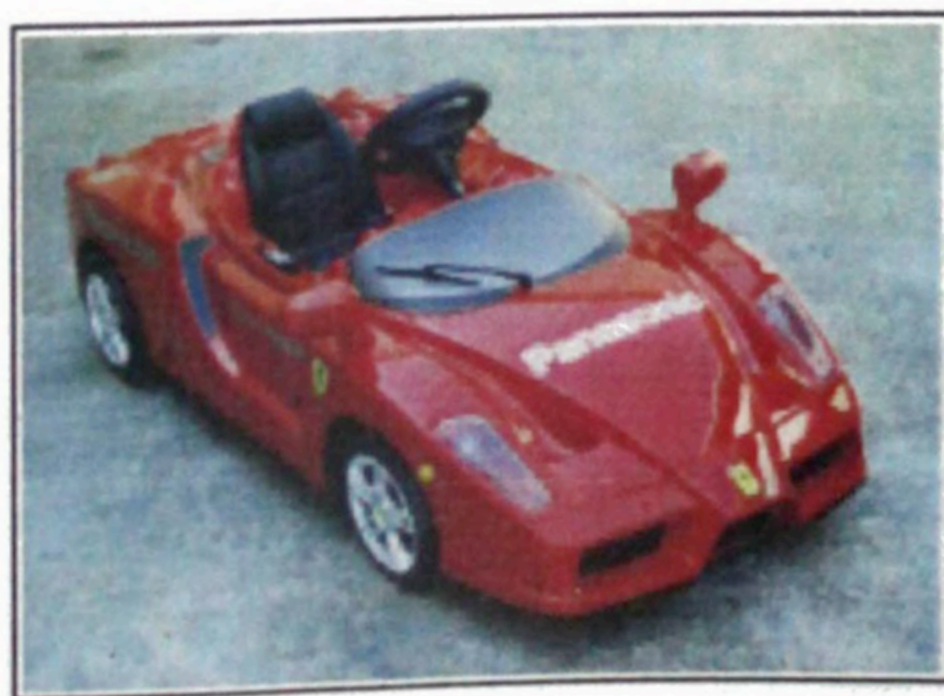
Fig.5-2 単3乾電池2本で走る子供用電動カート（2004年）
