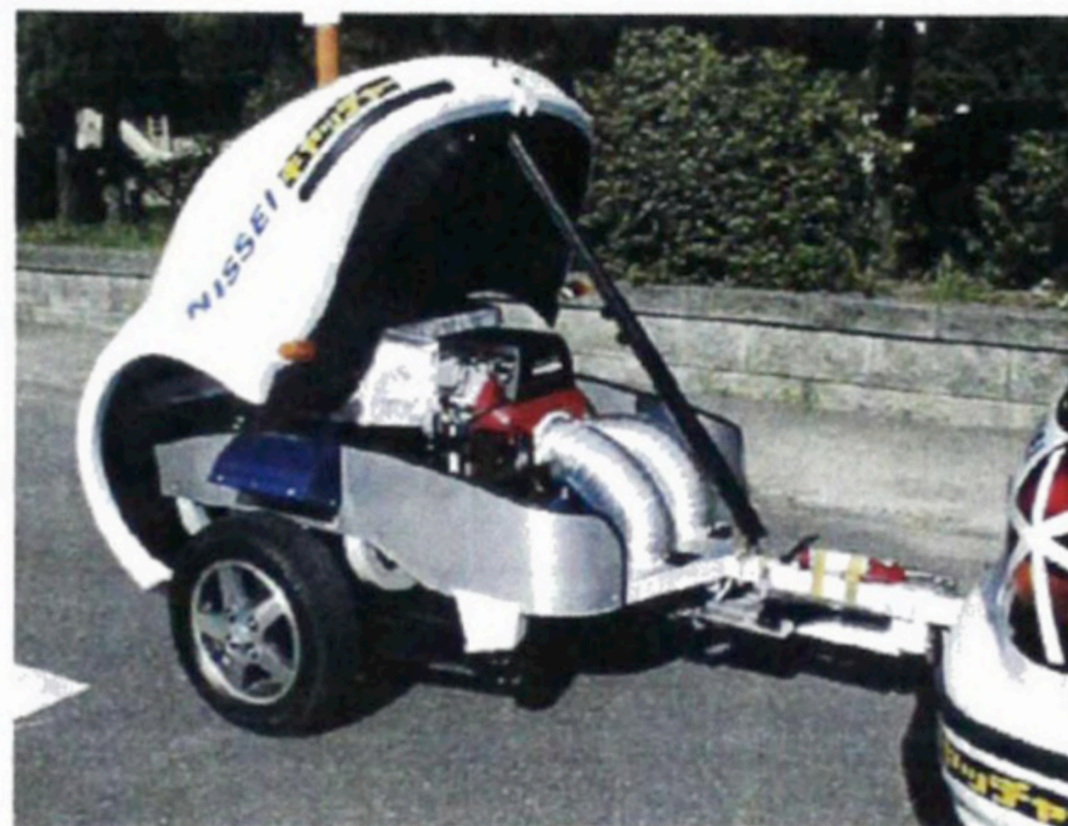
Fig.3-28 発電機搭載状態の写真
