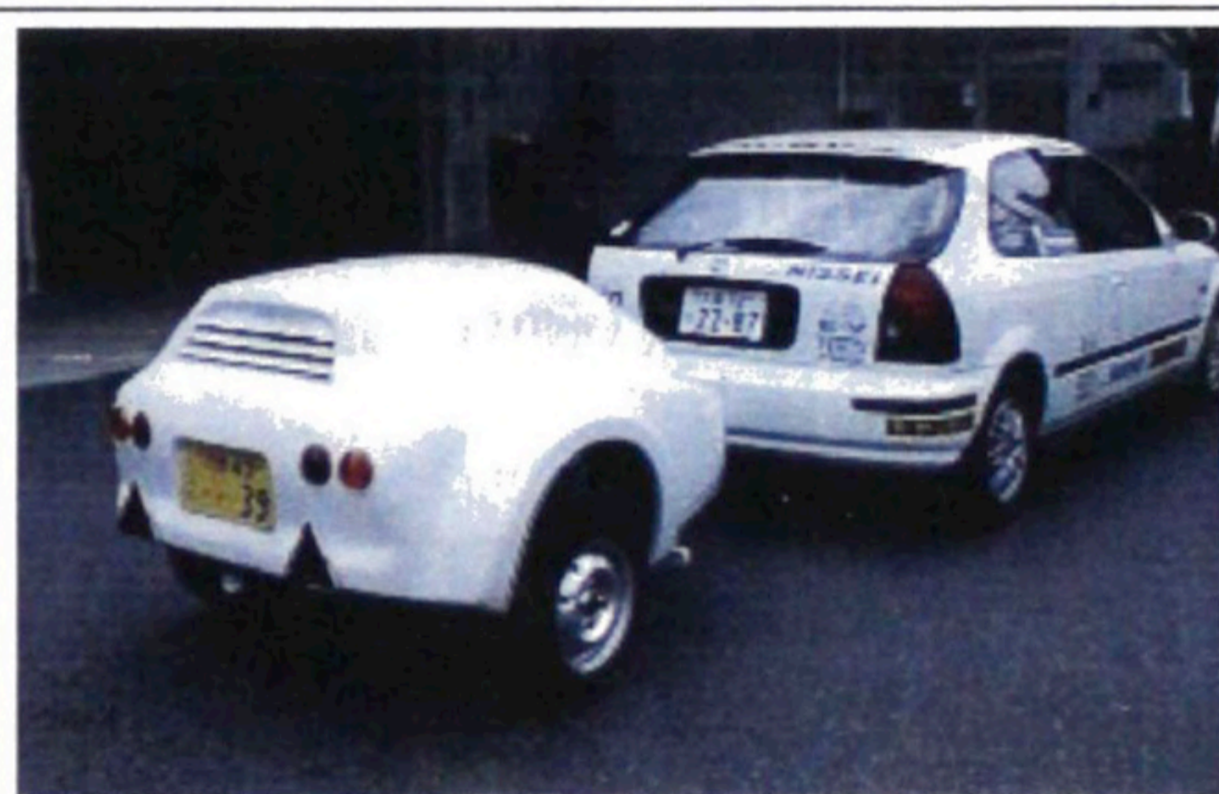
Fig.3-8 右（前側）けん引用電気自動車 左（後部）被けん引発電車
