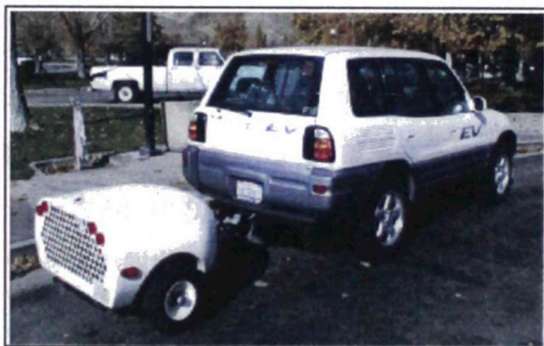
Fig.3-3 オートバイエンジンと発電機を組み合わせた RXT の例
