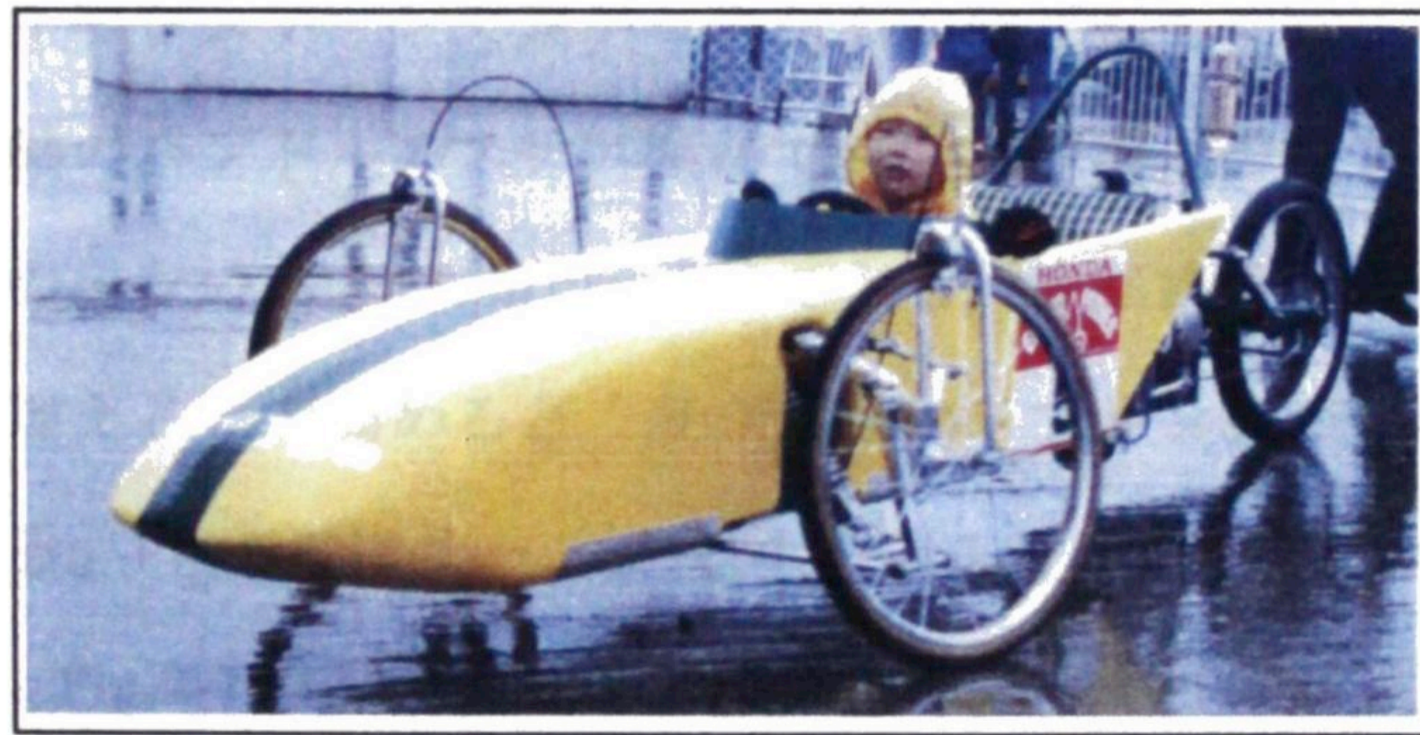
Fig. 2-2 リーン操舵システム1号車の写真
