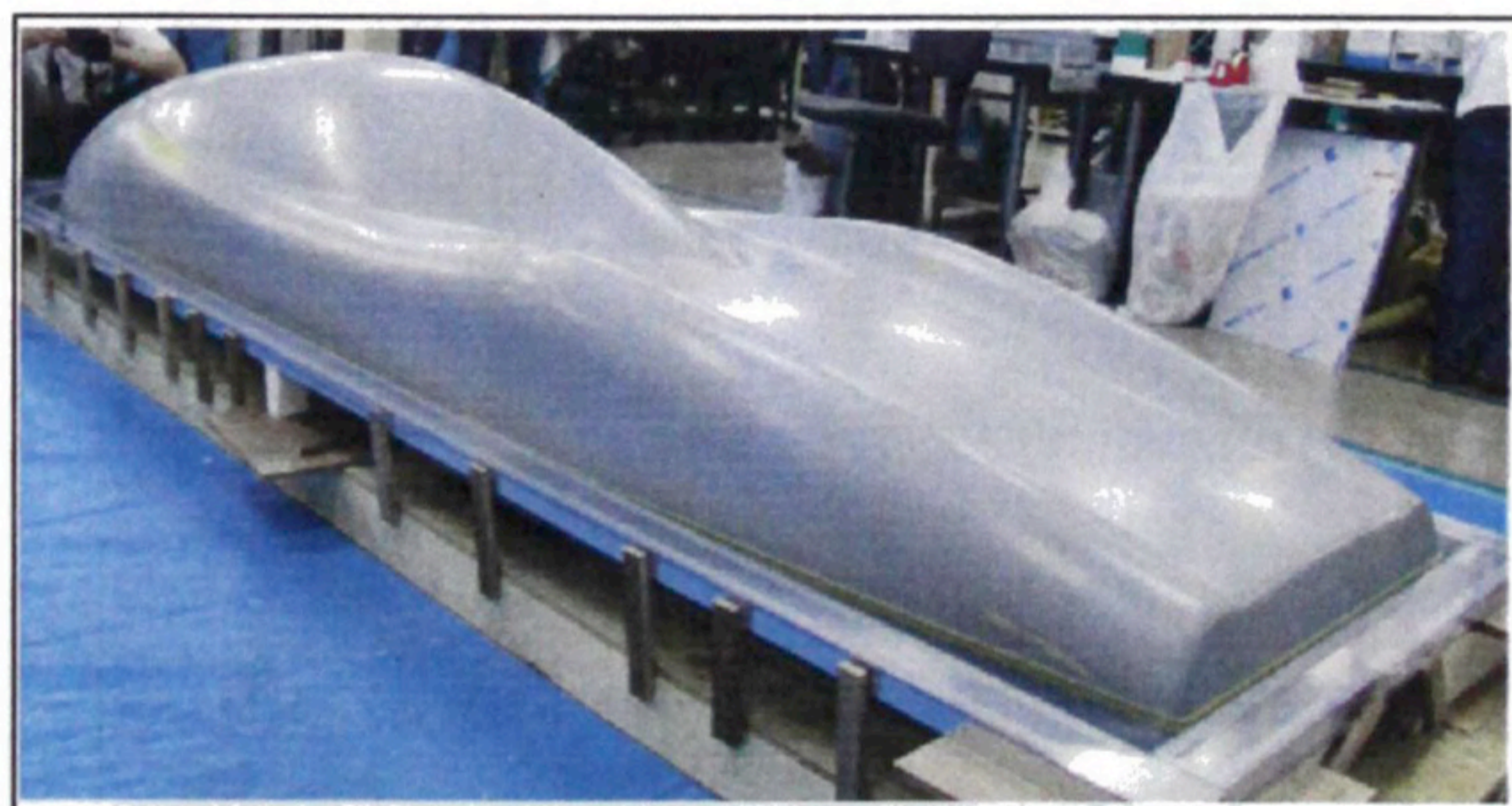
Fig.4-7 表面を樹脂で固め研磨して完成した1/1マスターモデル
