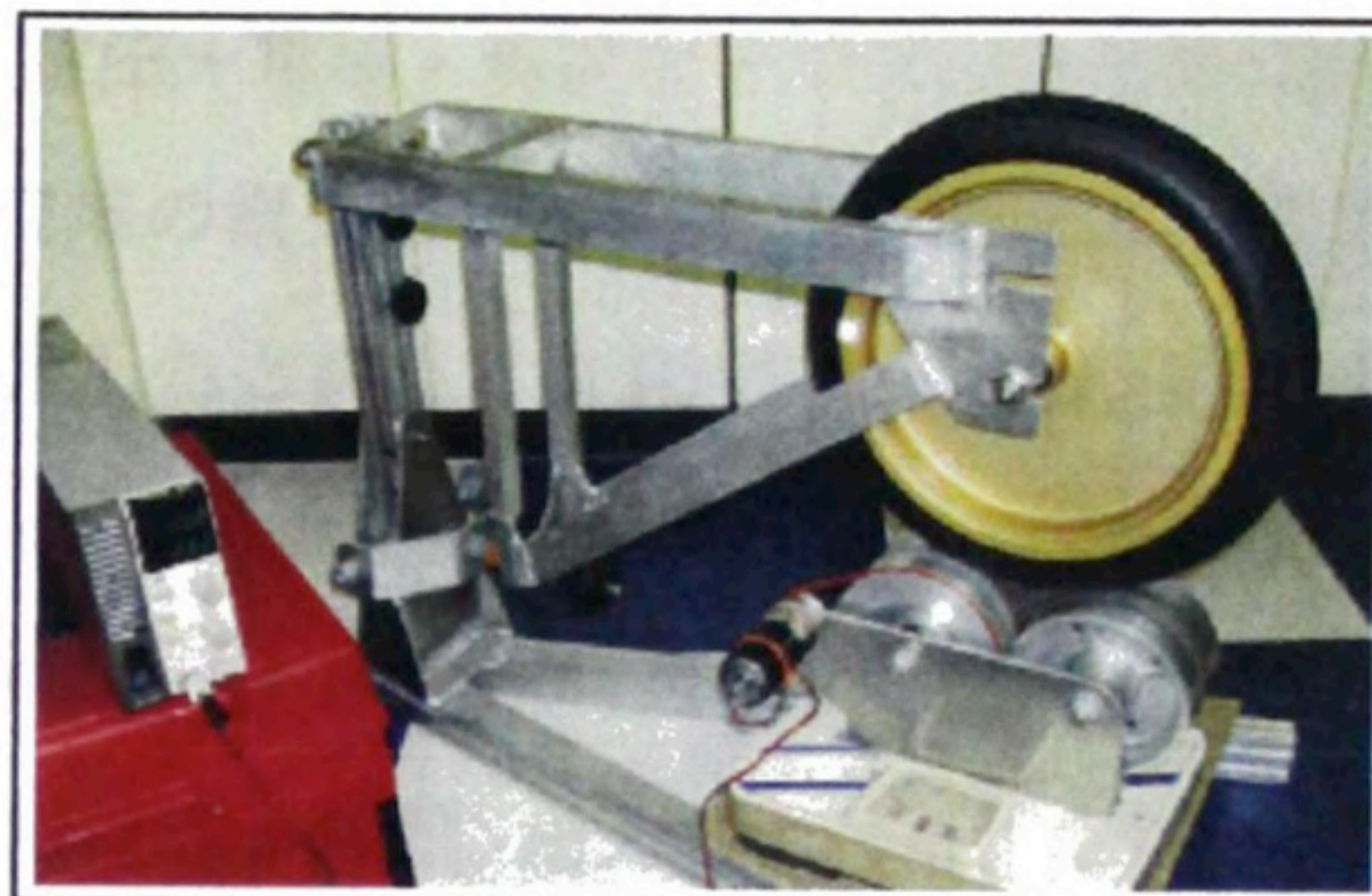
Fig.4-21 製作した専用タイヤの消費エネルギー測定の様子の写真
