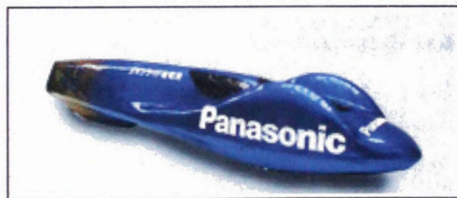
Fig.5-1 単3形オキシライド乾電池 ® 2本で走る小型電気自動車（2004年）
