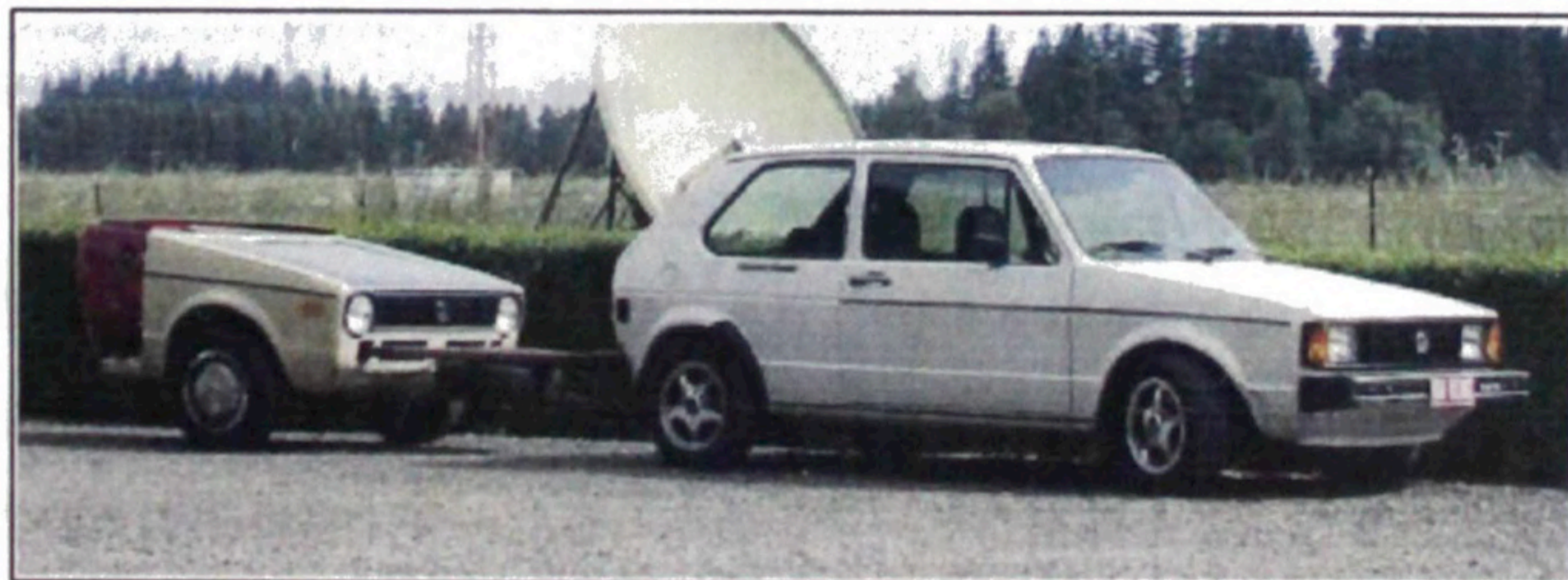
Fig.3-4 前輪駆動車の駆動部を使ったプッシュトレーラー [EV Maine.org、(参照 2006-10)]
