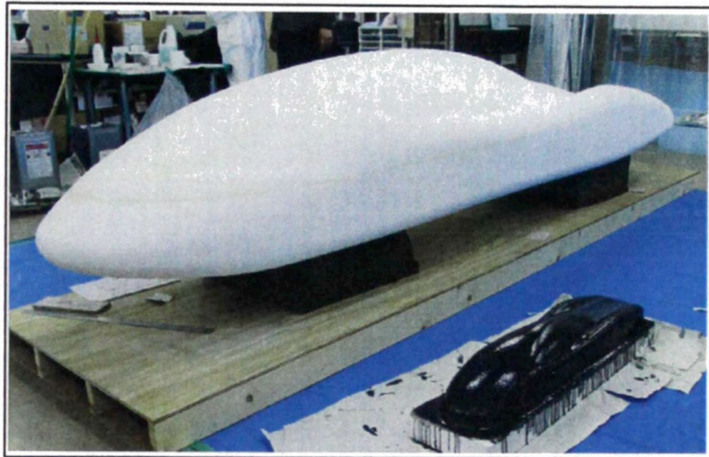
Fig.4-6 低発泡倍率の発泡スチロール樹脂を削ったマスターモデル
