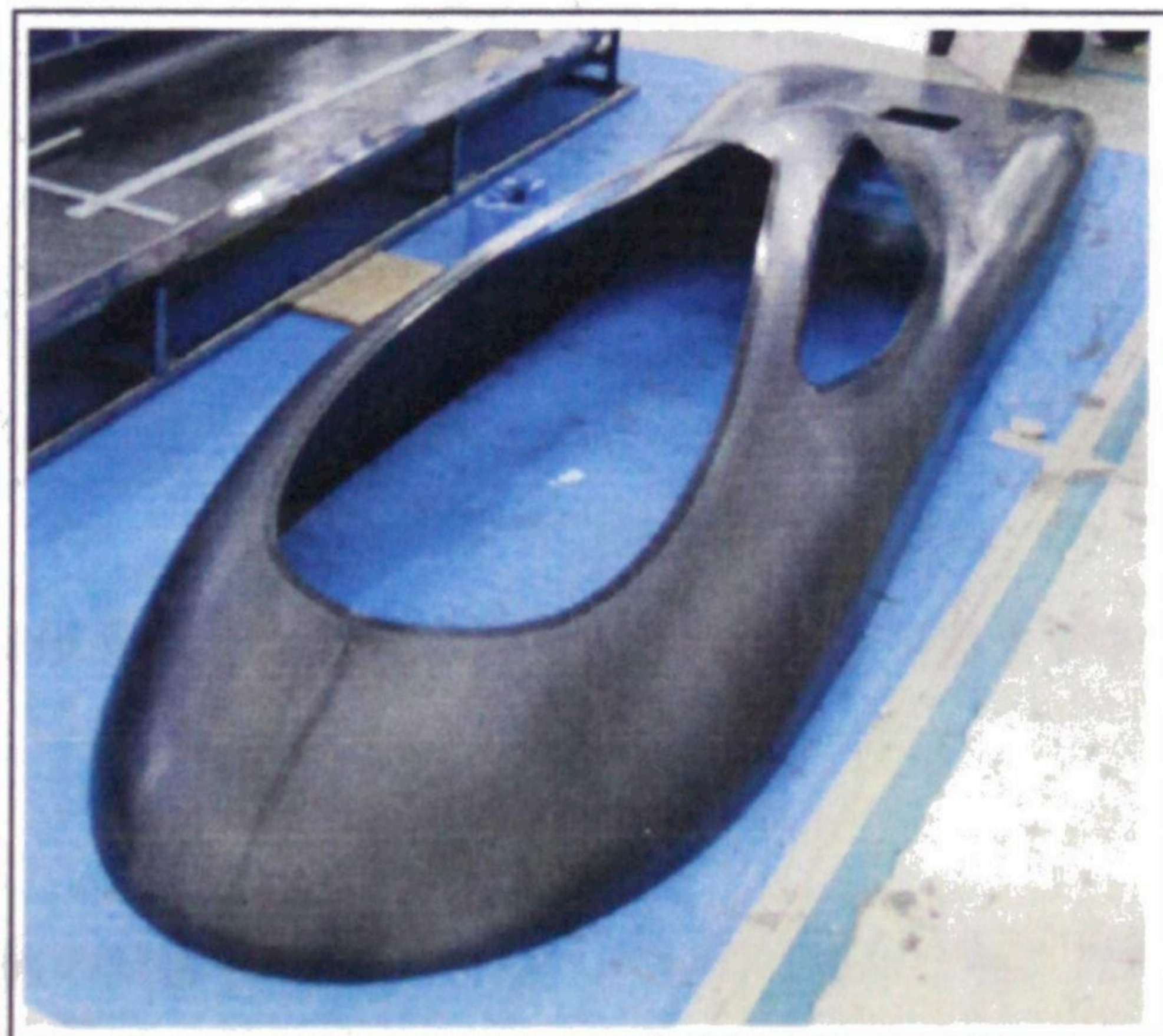
Fig.4-9 完成した CFRP 製車体上部
