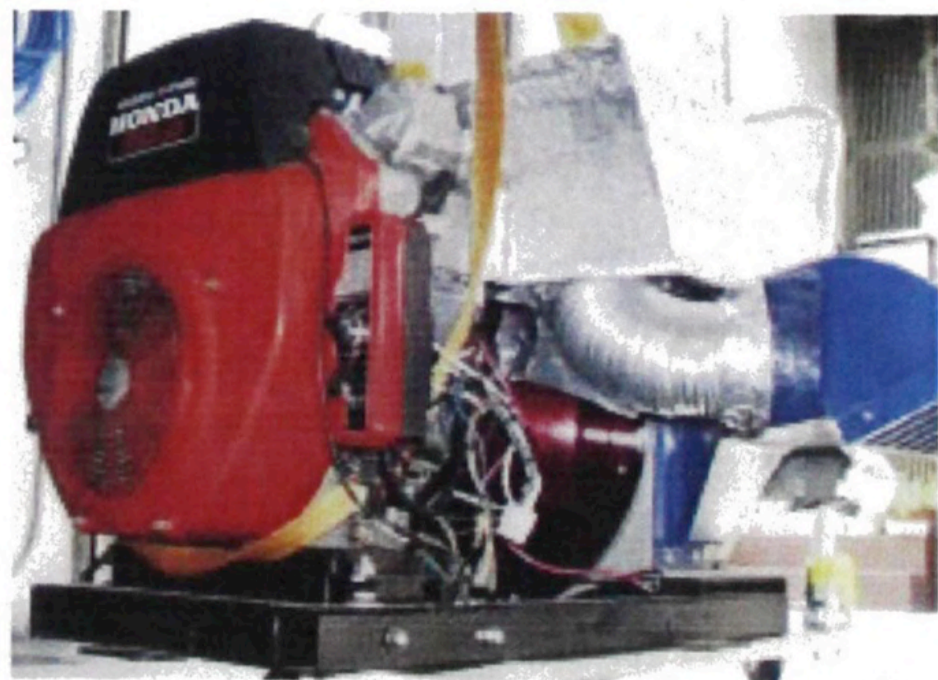
Fig.3-14 エンジン-発電機連結の写真
