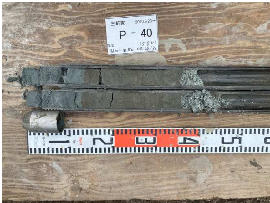
(4) SPT サンプラーによる試料採取状況
