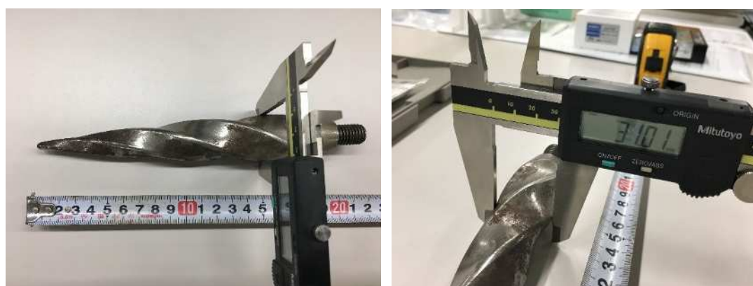
写真-3.5 SP最大径の計測状況の一例
