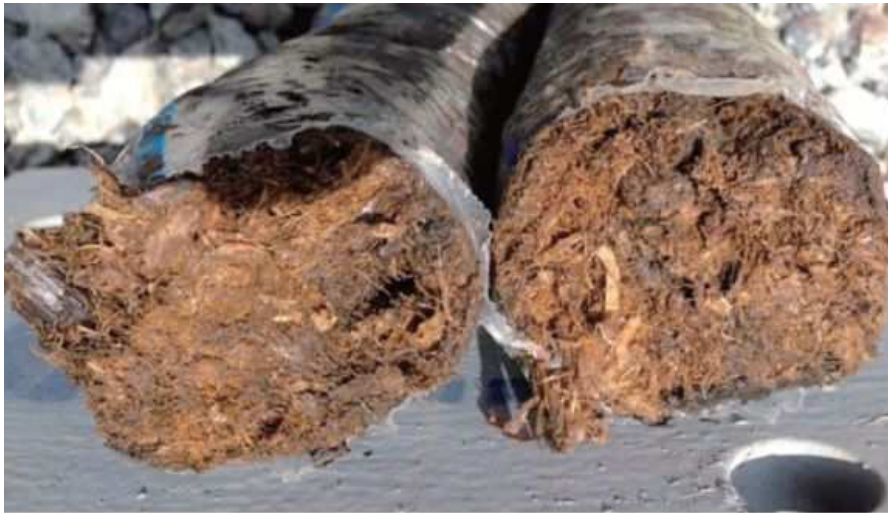
写真-1.7 諏訪湖南東部の高有機質土（泥炭） 24)
