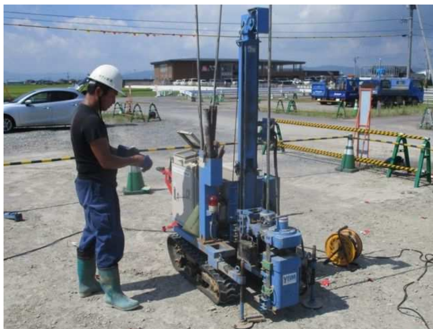
写真-2.3 ワイビーエム社製 全自動式試験機 (SWS-Y)
