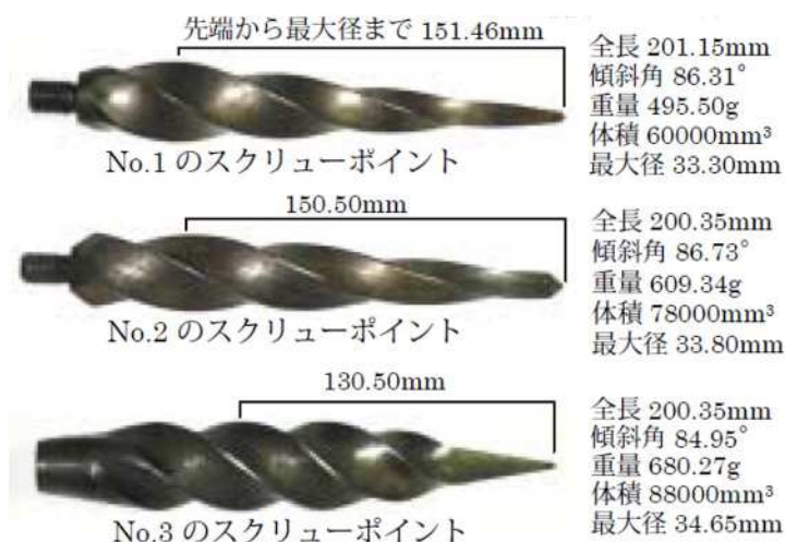
写真-1.4 スクリーポイントの形状 10)
