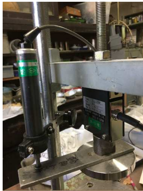
写真-2.6 変位計（左）、荷重計（右）
