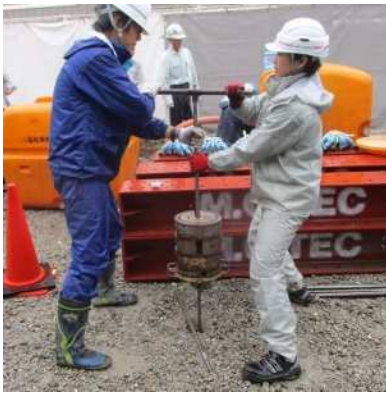
写真-1.1 手動式試験機 (1976年～)
