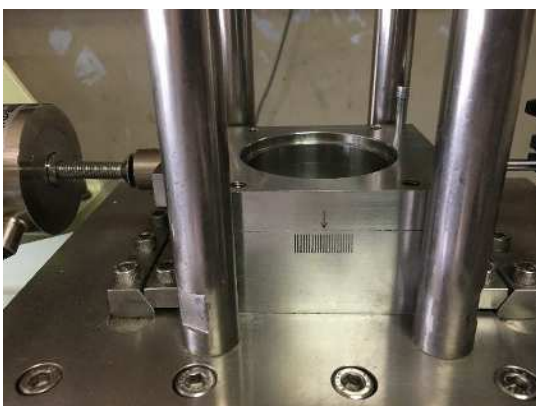
写真-2.10 せん断箱上下設置
