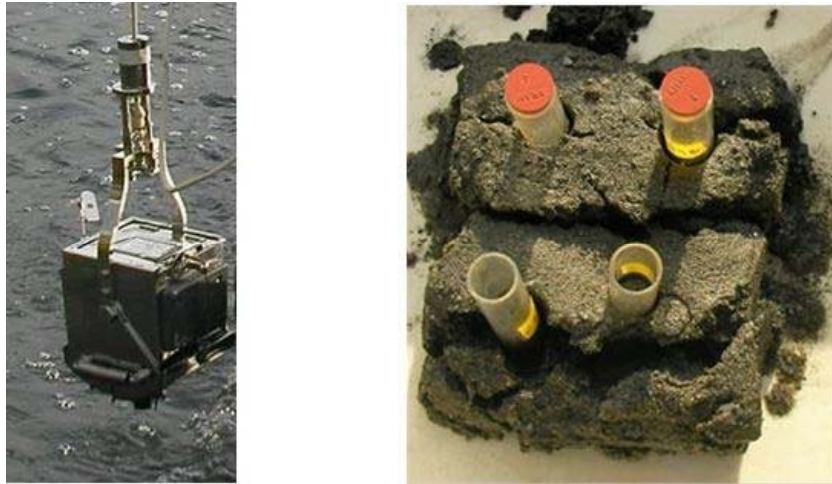
図 2-10 エクマンバージ採泥器の写真（左）コアサンプラーによる採取風景（右）
