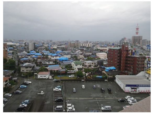
写真4 屋根部の被災状況を示すブルーシートの分布 （熊本市東区より南側を望む）
