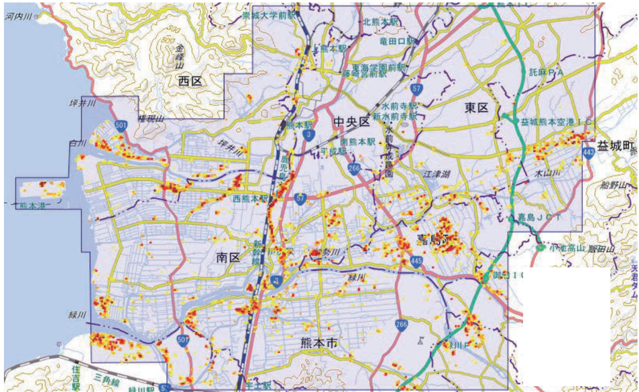
図2 空中写真からの液状化判読結果（熊本平野部） 2)
