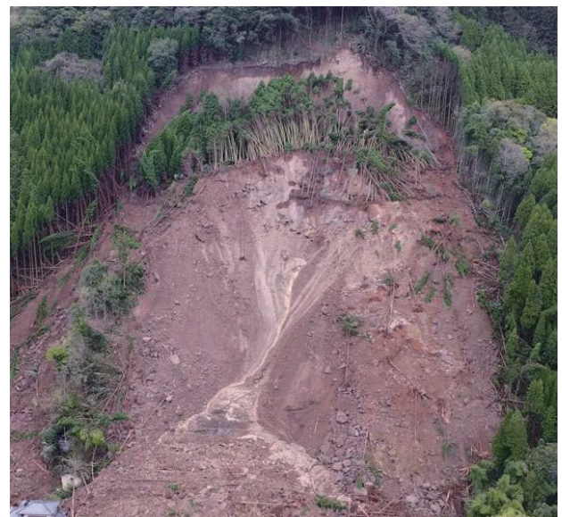
図20 崩壊斜面直下の湧水：大分大学撮影 3)
