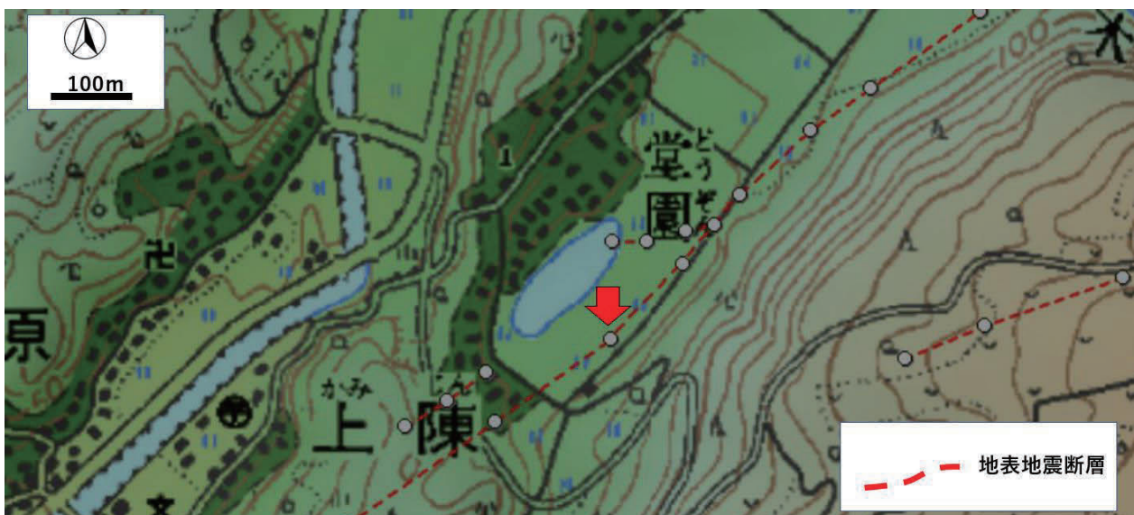
図1 堂園地区で最大変位が確認された地表地震断層の位置
