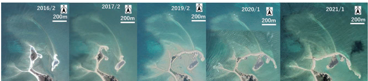
図15 岬先端部の砂嘴の発達過程（タイ国・パカラン岬付近）
