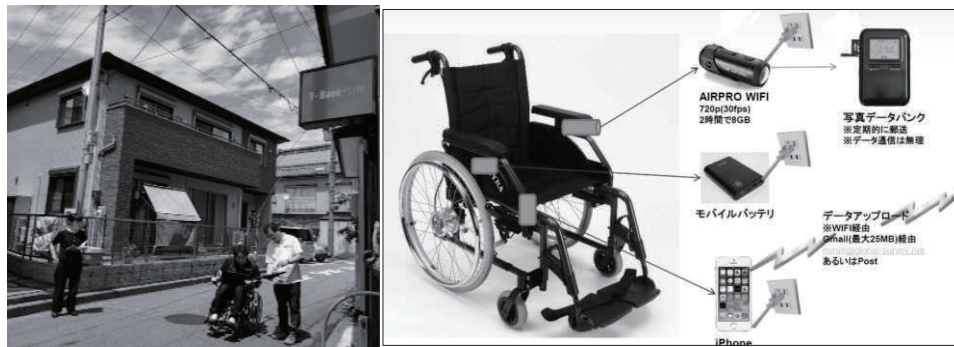
図6 センサー付車椅子の装備
