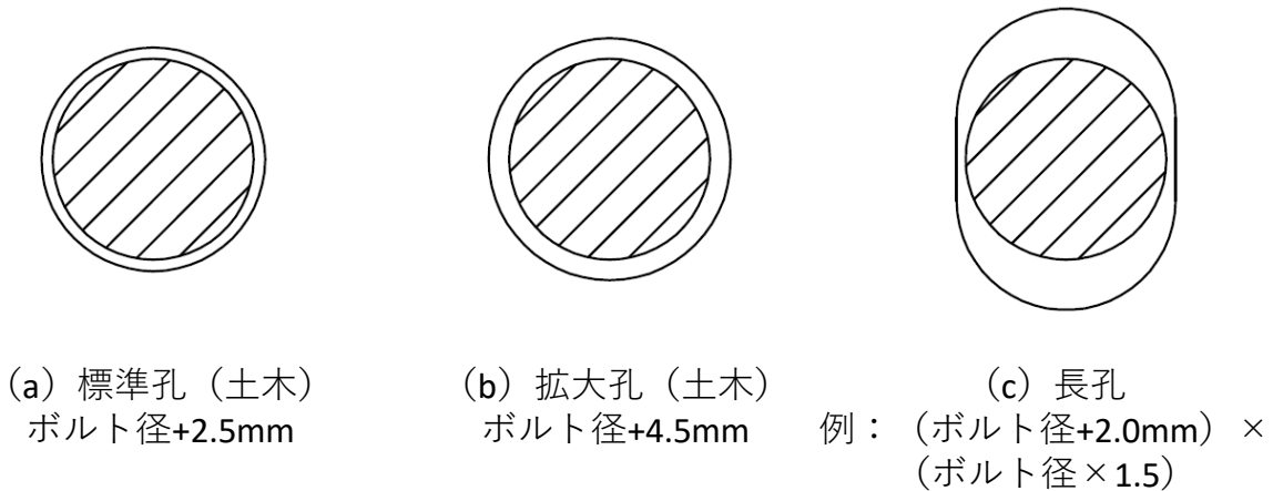
図 - 1.8 ボルト径とボルト孔の関係
