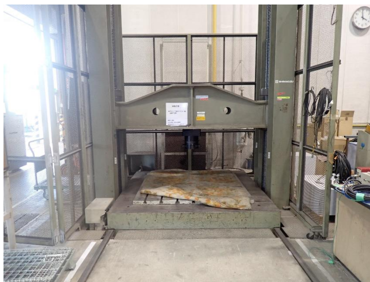
図 - 4.6 押し抜きせん断実験の荷重装置
