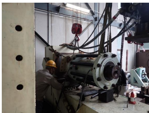
(a) 水平ジャッキの高さ調整
