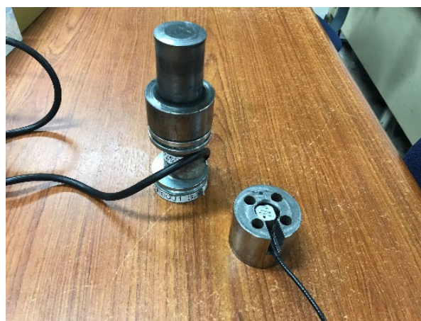
(3) 上加速度計を接着した様子
