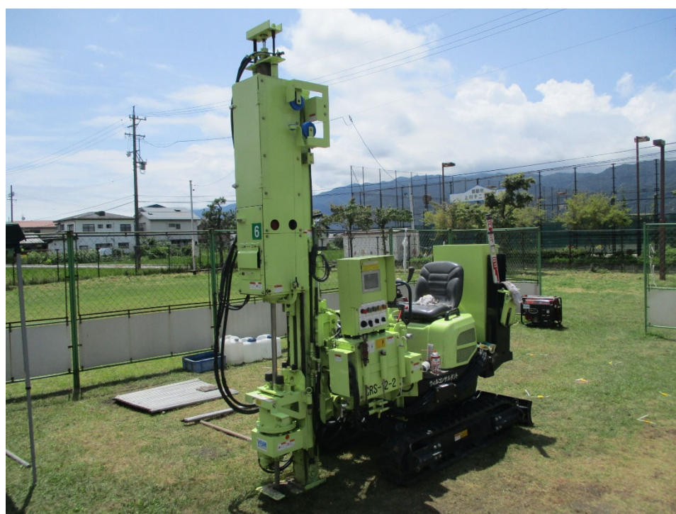
写真-1.1 大型動的コーン貫入試験の全自動式試験機の例（YBM 社製）
