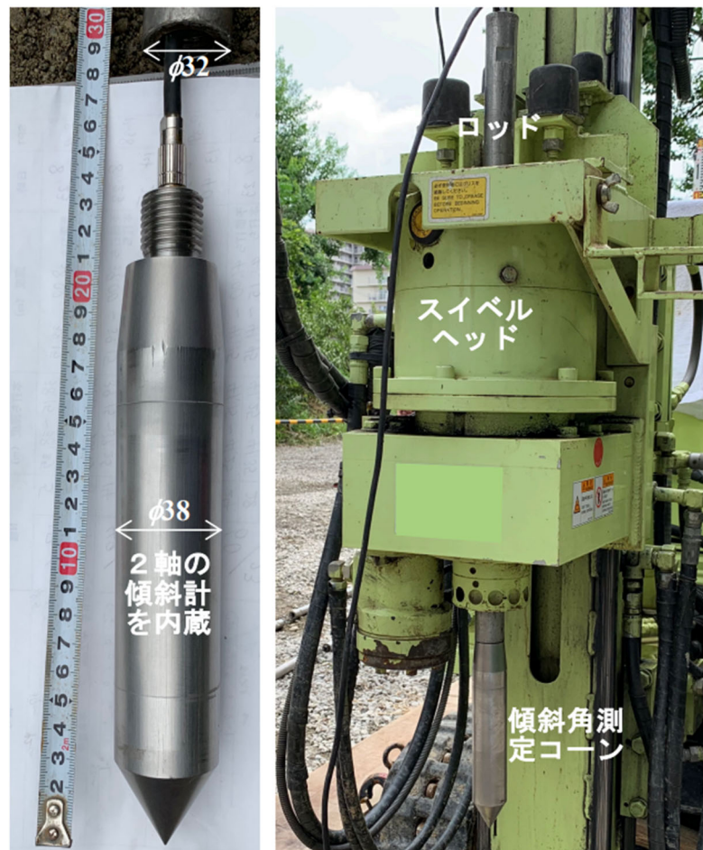
写真-3.1 傾斜角測定コーンと設置状況 5)
