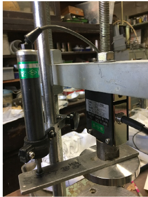
写真-2.6 変位計（左）、荷重計（右）
