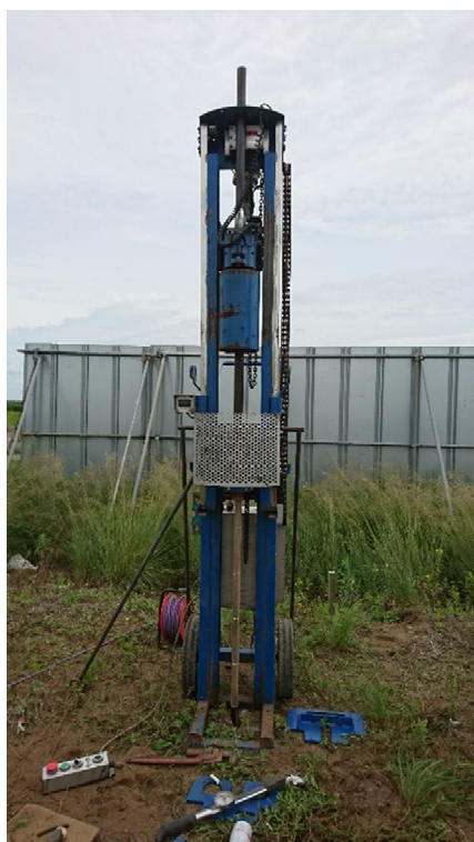
写真-2.3 H-DCPT の半自動式試験機の例 (トラバース社製)
