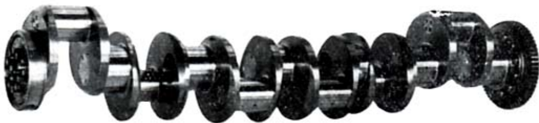
同上書、9頁、第六図。 右側が前方でファルマン減速装置との結合部、歯型継手の平歯車が、左端には最後部主軸受の円筒コロ軸受が見える。
