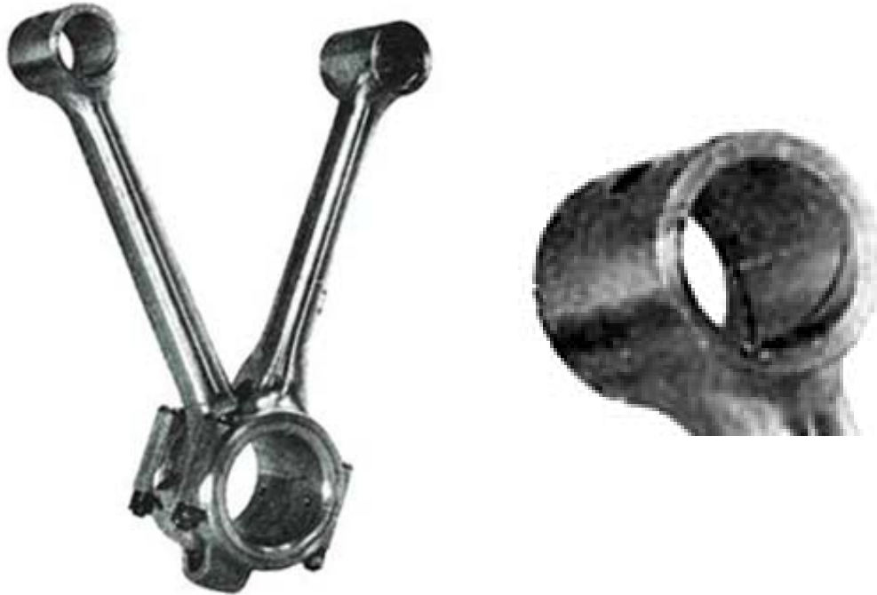
図IV-7 三菱イスパノ 450 馬力発動機一型の連桿とその小端部
