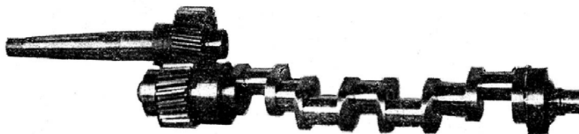
図III-6 イスパノ 220 馬力のクランク軸及びプロペラ軸
