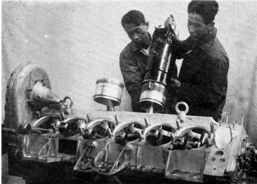
図V-9 三菱ユンカース「ユ式一型」800馬力発動機における気筒取付作業
