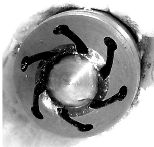
図 I -27 ノズル弁先端の小孔と渦巻き状の溝
